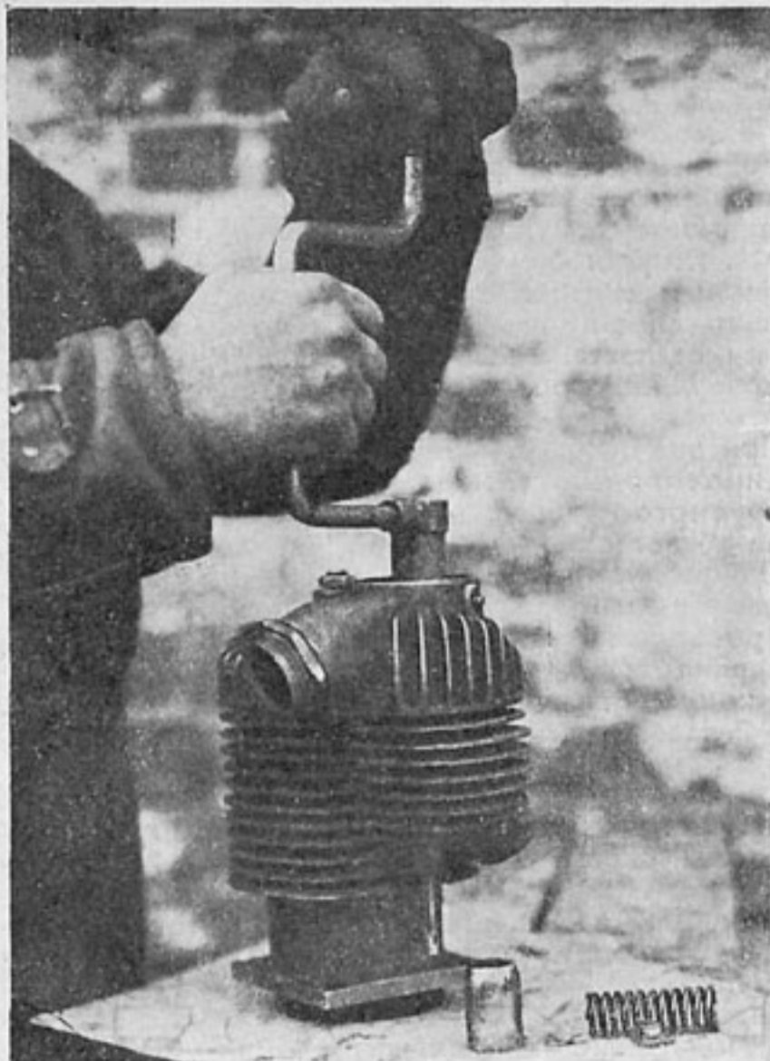
Притирка клапанов при помощи коловорота
